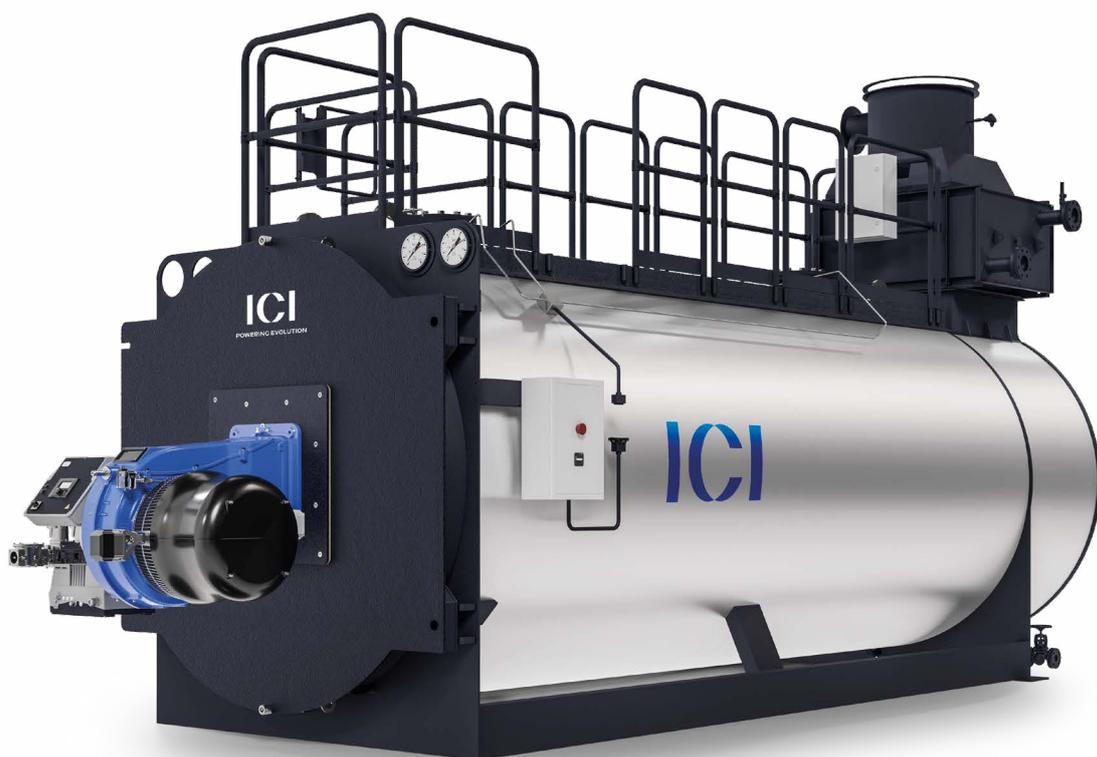
La gama TNX presenta generadores de calor de tubos de humo de tres giros reales con fondo mojado de funcionamiento automático, idóneos al funcionamiento con combustibles líquidos o gaseosos. Destinados a servir grandes instalaciones de calefacción, con potencias entre 3000 y 20000 kW y temperaturas de ejercicio entre 60 y 100°C., Los generadores son diseñados para una temperatura máxima de seguridad de 110°C.
